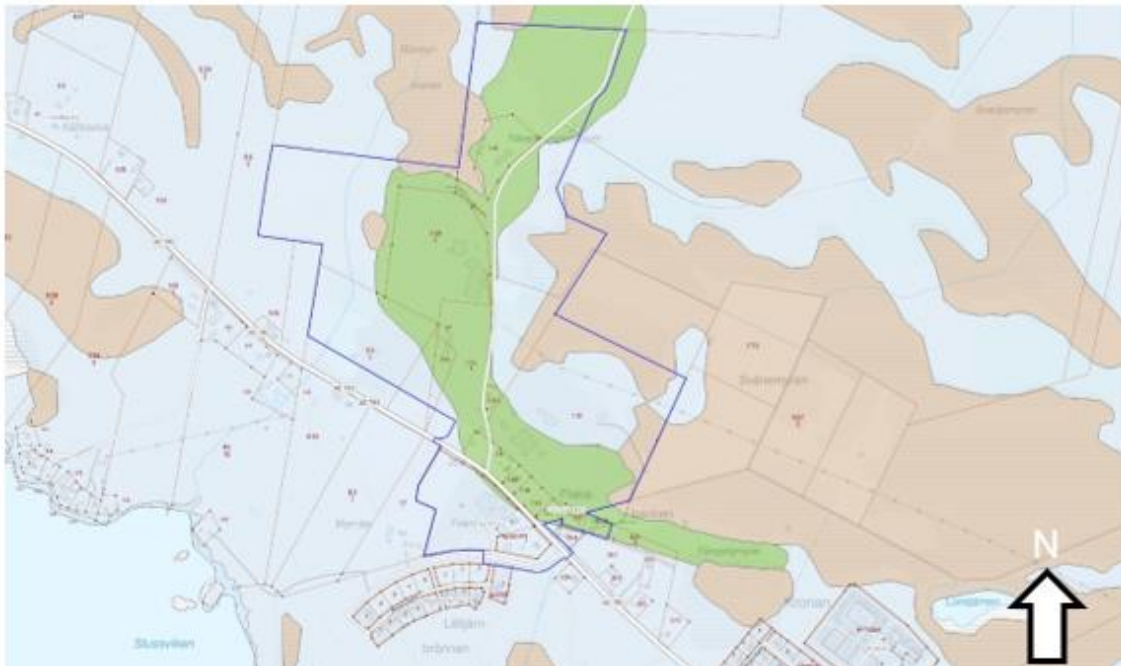
Figur 5. Jordartskarta 1:25 000 – 1:100 000 (SGU, 2022). Blå fält utgörs av morän, grönt av isålvssediment och brunt av torv. Planområdet är markerat med blå linje.
